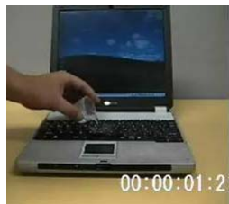
Foto de ingeniero de seguridad del producto TÜV probando el teclado a prueba de salpicaduras. Ahora, los usuarios disponen de más tiempo para guardar sus datos y apagar su portátil en caso de una salpicadura accidental.
