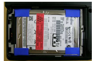
Protección de HDD: una combinación de material absorbente de impactos y el exclusivo sistema de supervisión del movimiento de 3 ejes de Toshiba.
